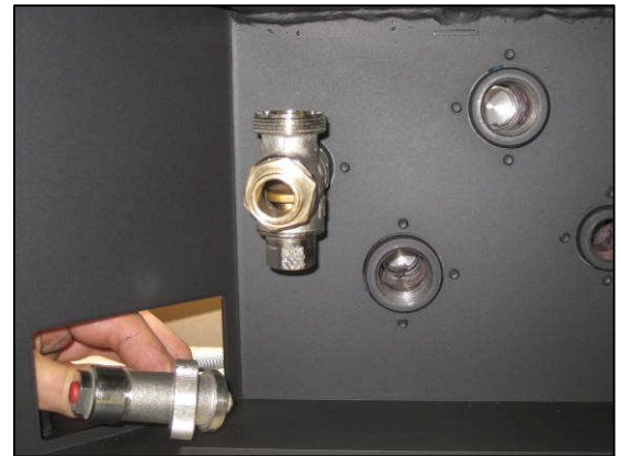
(Abb.: Verlegung Ventileinsatz)
